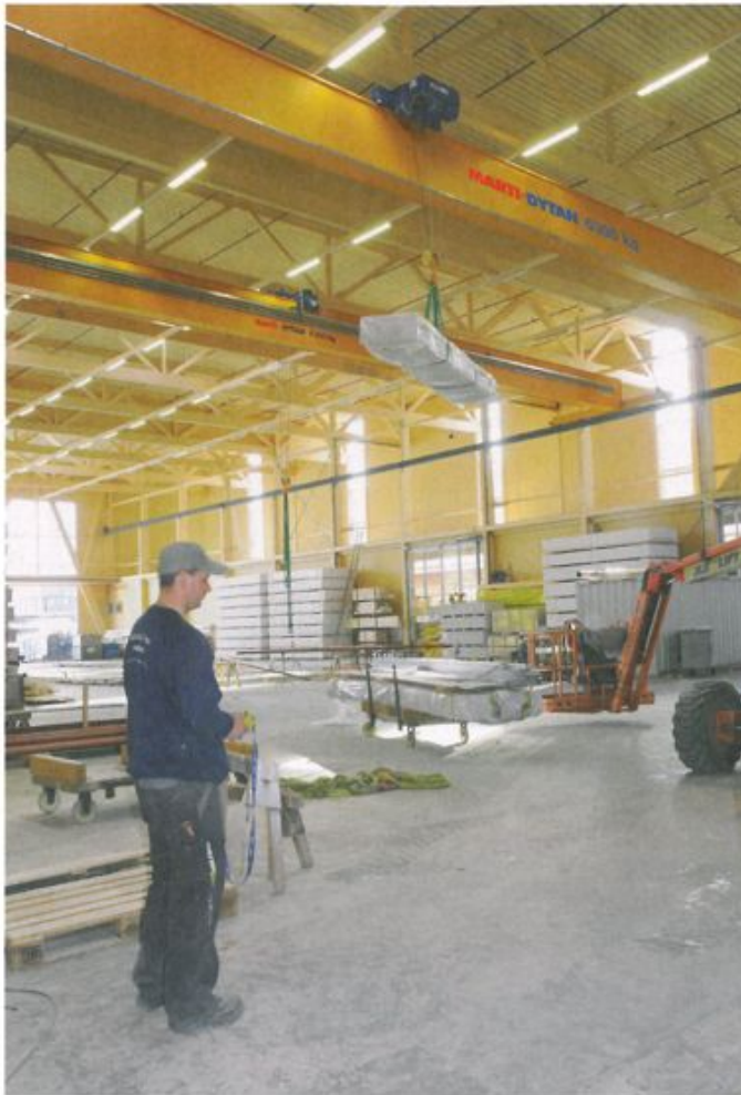
Die beiden Abus Einträger-Laufkrane Typ ELS-6300 mit 6,3 Tonnen Tragkraft sind mit einer Seitenlaufkatze versehen.
